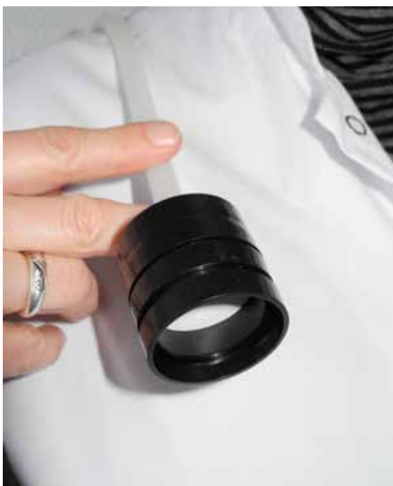
Cassette de prélèvement utilisée pour évaluer la concentration en fibres d'amiante dans l'air des lieux de travail
